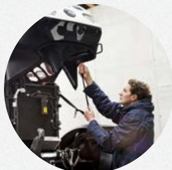
Jednodelna hauba nošena na gasnim amortizerima se može podići u dva položaja (45°/90°) čak i sa prednjim oruđem.
