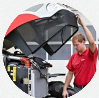
Jednodelna hauba motora na gasnim amortizerima se može podići čak i kada je napred priključeno oruđe.
