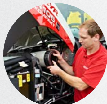
Stalno čišćenje preko Piclon filtera osigurava da filter treba održavati samo kada se upali odgovarajuća lampica upozorenja.
