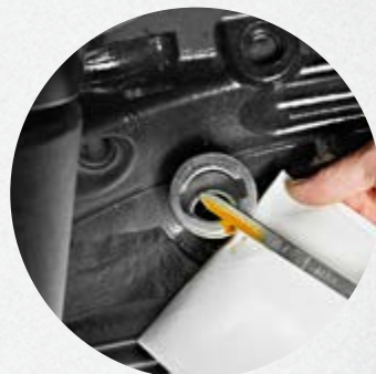
Provera nivoa ulja i dosipanje bez podizanja haube.
