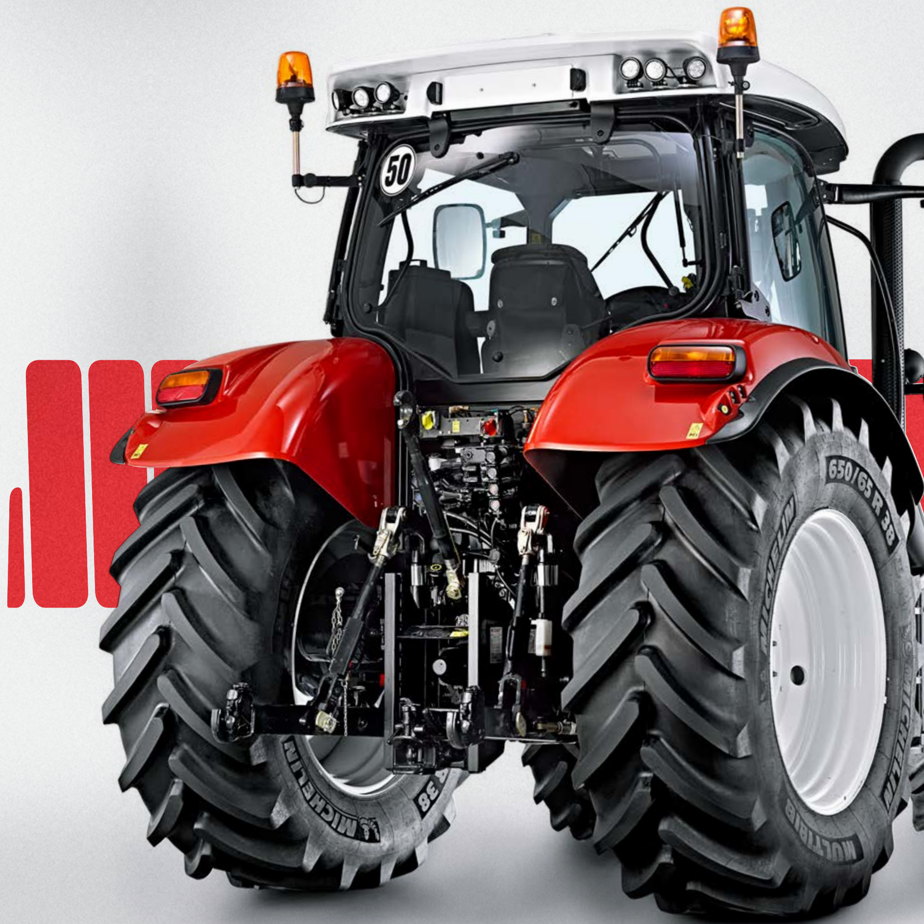
Profi Classic opremljen mehaničkim kontrolnim uređajima i elektronskom kontrolom kačenja (EHR).
