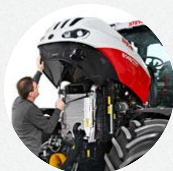
Jednodelna hauba nošena na gasnim amortizerima se može podići u dva položaja (45o/90o) čak i sa prednjim priključkom.
