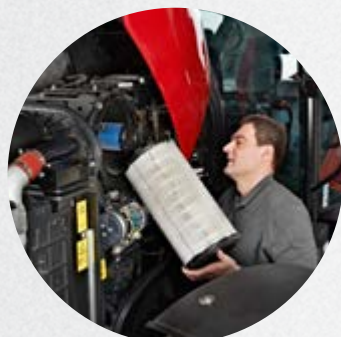
Stalno čišćenje preko Piclon filtera osigurava da filter treba održavati samo kada se upali odgovarajuće svetlo upozorenja.
