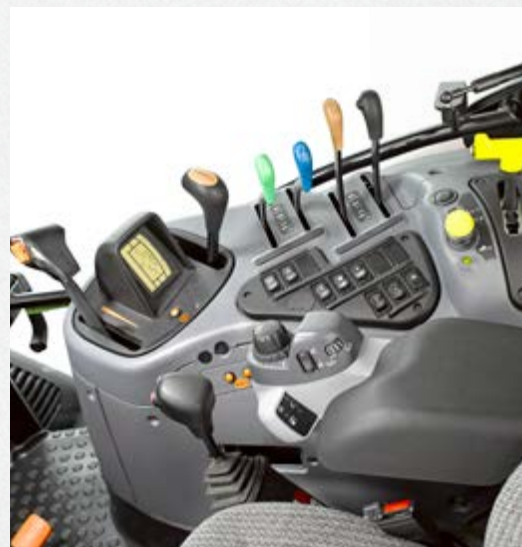
Profi Classic opremljen mehaničkim kontrolnim uređajima i elektronskom kontrolom kačenja (EHR).
