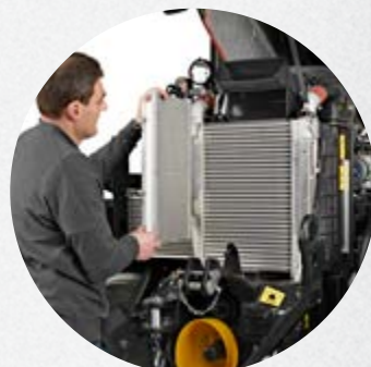
Brzo i jednostavno čišćenje hladnjaka.
