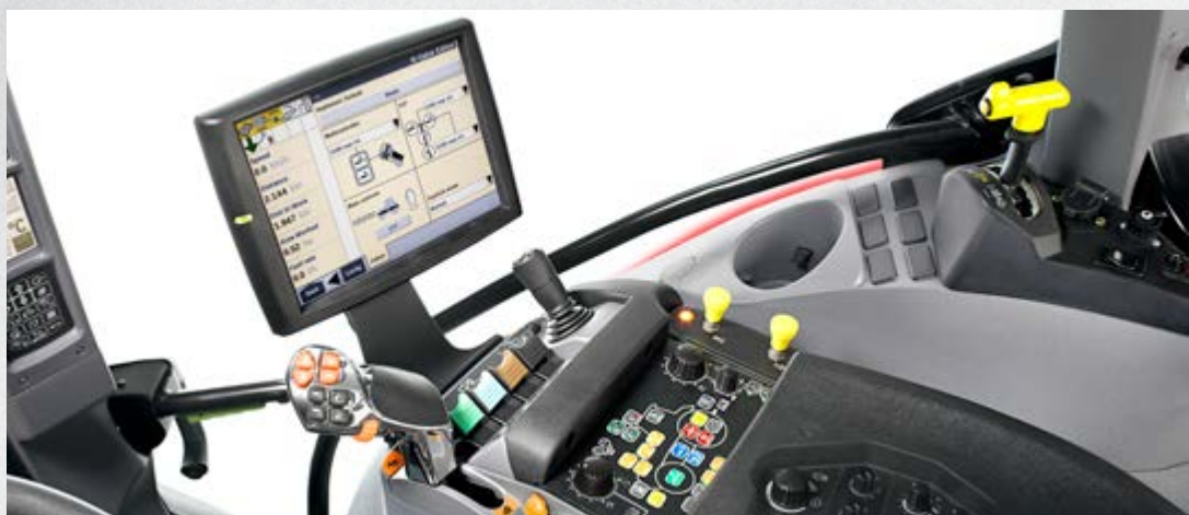
Profi i Profi CVT su opremljeni sa po 4 elektronska kontrolna uređaja.
